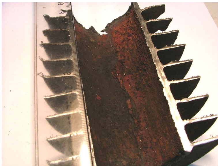
شکل ۲. تصویر سطح داخلی تیوب اکونومایز و رسوبات خوردگی تشکیل شده روی آن
