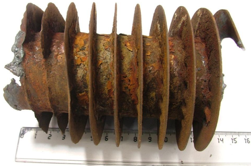
شکل ۱. تصویر تیوب اکونومایز که دچار خوردگی شده است
